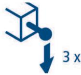
Wird der rechte Bedienhebel drei Mal nach unten betätigt, so werden die **Blinkleuchten** bei geöffneter Plattform **ausgeschaltet**, zum Beispiel beim Einsatz an der Rampe.
