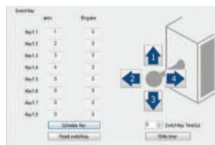
SwitchKey ersetzt den bisherigen elektrischen Schlüsselschalter. Soll die Bedienfolge angepasst werden, so ist dies mit der Diagnosesoftware **Bär CargoCheck** möglich.
