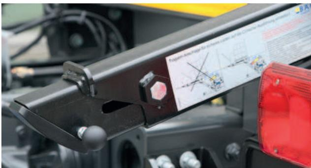
**Butée de bras porteur** (option) vissée pour différentes longueurs de caisse mobile BDF. Parfaite possibilité de réglage pour un chargement et déchargement efficace.
