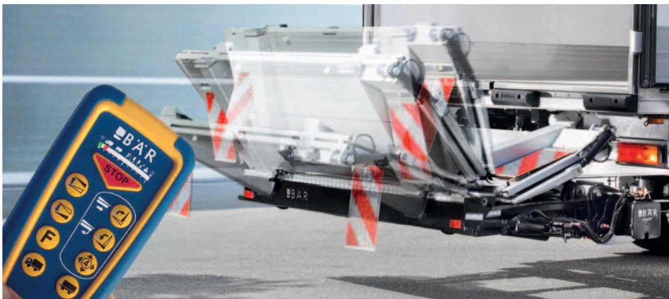
Déjà présent sur le marché depuis 1994, le groupe de produits Bär Cargolift Ret/HydFalt n'a rien perdu en force d'innovation. En effet, sur les Cargolifts HydFalt, non seulement le système de rétraction, mais aussi le pliage bénéficie d'une assistance hydraulique. Au quotidien, ceci augmente le confort de manipulation et rend le Cargolift plus rapidement disponible. La plateforme en aluminium anodisé de série confère en outre une optique élégante et un meilleur vieillissement.
