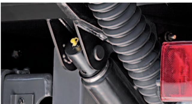
Vérin hydraulique avec **gaine de protection** ou **soufflet de vérin** (série) en tant que protection contre les gravillons et la corrosion.
