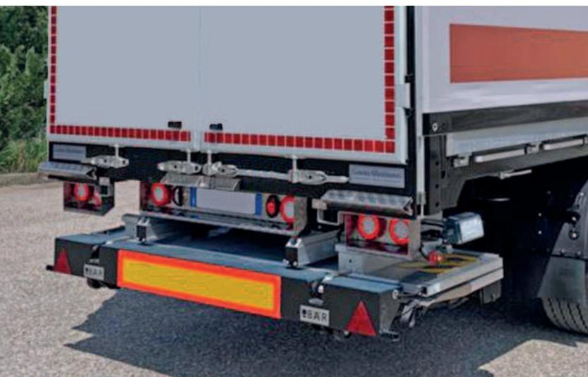
Le Cargolift pour des tâches complexes de logistique : BC R42. Grâce au pliage en deux fois de la plateforme, ce Cargolift disparaît en position route de façon compacte sous le véhicule. Après une extraction motorisée et un dépliage manuel de la plateforme assistée par ressort, il est rapidement prêt à entrer en action. Le véhicule peut donc être librement utilisé en alternance dans la distribution ou le transport grande distance.
