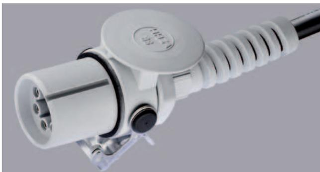
**Ligne de recharge SmartCharge** SC-VEHH à commande électronique (option) en tant que connecteur homologué pour changer de véhicule tracteur et de remorque à sa guise. La commande intelligente assure une tension de batterie suffisante en permanence. Affichage des anomalies par signaux clignotants.
