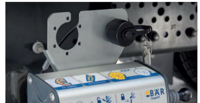
**Commutateur à clé électrique externe** (option) en vue d'un montage sur le support du boîtier de commande. Empêche toute manipulation involontaire alternative au SwitchKey.
