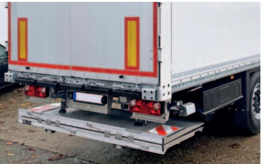
Для профессионального использования однократно складываемых, убираемых вниз гидробортов модель BC 2500 R4T отличается уникальным соотношением собственного веса и нагрузочной способности. Платформа глубиной до 2010 мм и значительный грузовой момент 25,0 кНм обеспечивают надёжность транспортировки даже тяжёлых громоздких грузов. Доступен разгруженный вариант, имеющий допустимую нагрузку 2 тонны.
