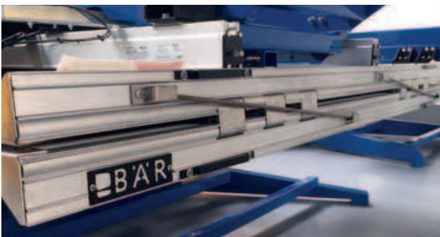
Ручное складывание окончания платформы удобно для оператора за счёт **снятия нагрузки с пружины** (серия).
