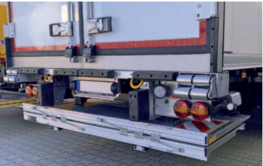
Оптимален для монтажа на седельном полуприцепе благодаря высокой степени предварительной сборки и подвеске с захватом, быстро готов к использованию благодаря однократному складыванию платформы – так можно описать любой гидроборт из группы изделий RetFalt. BC 2000 R2T используется, прежде всего, для транспортировки тележек или для палет вилочным автопогрузчиком.
