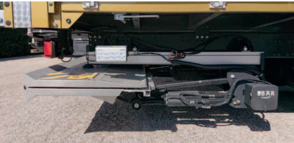
Высокая степень предварительной сборки в сочетании с гибким использованием без необходимости значительного техобслуживания – это достоинство гидроборта Bär Cargolift RetFalt. Эти убираемые вниз гидроборта с помощью прикрученной подвески могут быть быстро смонтированы на грузовом транспортном средстве или с помощью подвески с захватом – на седельном полуприцепе.
