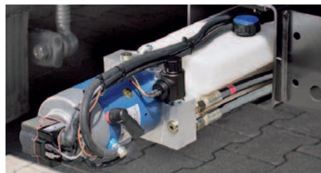
**Агрегат и система управления** надёжно защищены в несущей балке (серия). Защитный термовыключатель предохраняет двигатель от перегрева и возгорания. Простое **аварийное управление** четырьмя основными функциями при помощи кнопок. Имеется в распоряжении **агрегат пониженного шума** (опция).
