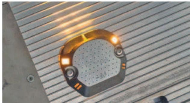
Прочные светодиодные сигнальные фонари **CargoFlash** (серия) с большой интенсивностью света и очень хорошим вертикальным излучением при сниженном токопотреблении.
