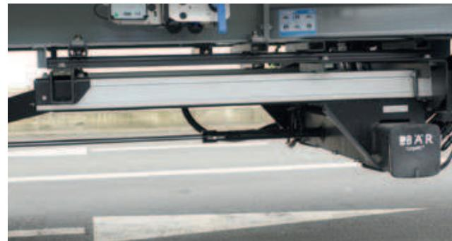
**Ведущее устройство** (серия) с направляющей скольжения, не требующей техобслуживания, и максимальной устойчивостью – для частого и длительного использования. Отличная синхронизация.
