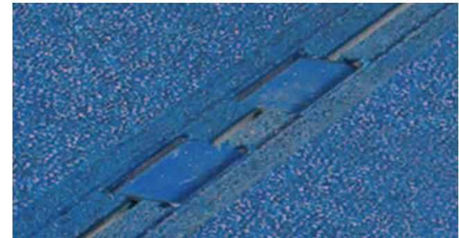
Гидроборта RetFalt в Piek-версии наряду с **цилиндром смещения с торможением в конце хода** оборудованы **также шарирными наладками** с покрытием.
