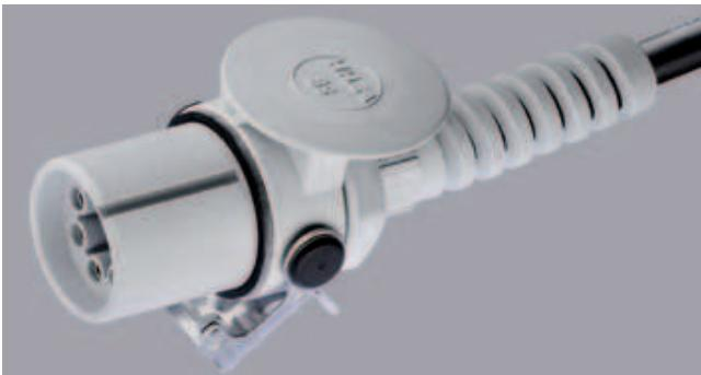
Линия зарядки **SmartCharge SC-VEHH** (опция) с электронным управлением как стандартное штекерное соединение для любой замены тягача и прицепа. Интеллектуальная система управления обеспечивает достаточное напряжение аккумулятора на месте выгрузки. Индикация неисправностей мигающим сигналом.
