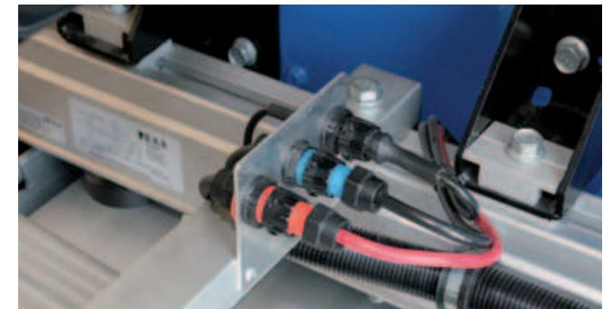
**Электрический разъём VDHH** (серия) для простого электроподключения.
