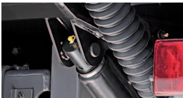
Гидроцилиндр с **защитной трубой** или **гофрированным чехлом** (серия) как защита от удара камнями и от коррозии. Одновременно быстрое автоматическое открывание с помощью цилиндров наклона двойного действия – даже в зимнее время.
