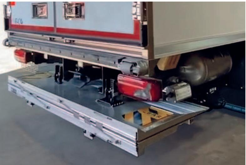
Как гидроборт для грузовых транспортных средств с допустимым общим весом 8,6-18,0 т и несъёмными фургонами любого вида модель BC 1500 R21 пригодна для разностороннего использования. Её платформа глубиной 1710 мм обеспечивает возможность транспортировки тележек или палет вилочным автопогрузчиком. Кроме того, этот однократно складываемый и убираемый вниз гидроборт может быть быстро приведён в состояние готовности к использованию.
