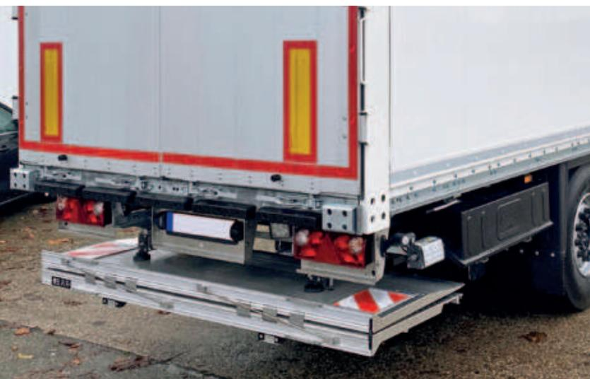
Per un utilizzo professionale di Cargolift retrattile con un solo ripiegamento, il modello BC 2500 R4T offre un rapporto unico tra peso proprio e carico ammissibile. La piattaforma, profonda fino a 2010 mm, come anche il potente momento di carico, pari a 25,0 kNm, rendono possibile trasportare anche carichi pesanti e voluminosi in sicurezza. Disponibile variante con 2 tonnellate di portata.
