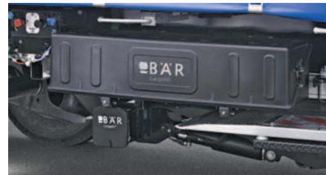
Disponibile una **BatteryBox** Bär (opzionale) per il montaggio laterale sotto alla struttura.
