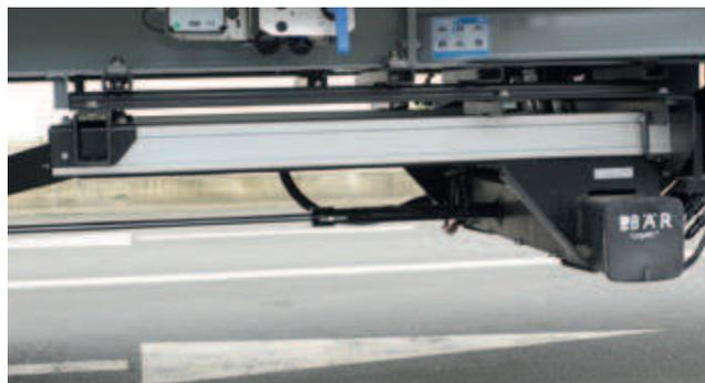
**Meccanismo di scorrimento** (di serie) con guida ed elevata robustezza – per un uso frequente e continuo. Ottime caratteristiche di avanzamento.
