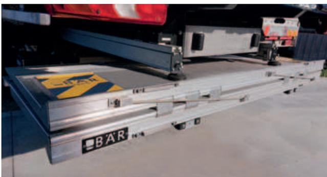
Ripiegamento manuale dell'estremità della piattaforma con **molla elastica (barra di torsione)** (di serie).
