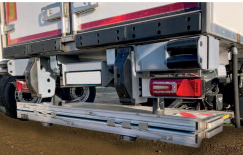
Retrattile, potente, compatto o, in altre parole, BC R4K. Questo Cargolift RetFalt offre un potente momento di carico di 20 kNm o 25 kNm. Appositamente progettato per semirimorchi urbani e rimorchi con interasse di 1300 mm, BC R4K si adatta perfettamente al veicolo portante. Allo stesso tempo, questo Cargolift, con la sua piattaforma in alluminio a singola piega, può essere utilizzato in diversi modi. La cosa migliore è provarlo!
