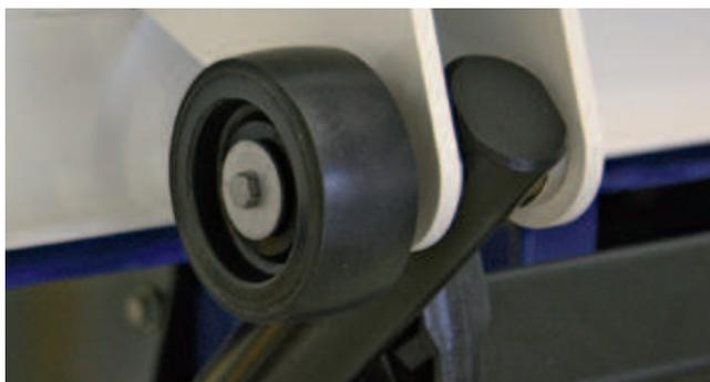
I **rulli per il terreno** con strato in gomma supplementare attenuano il rumore. Tutti i Cargolift RetFalt dispongono di un **gruppo a funzionamento silenzioso**.
