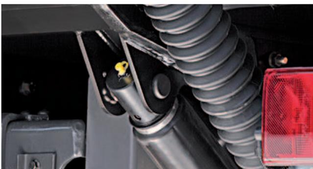
Cilindri idraulici con **tubo di protezione o soffietto** (di serie) come protezione contro gli urti di pietre e dalla corrosione.
