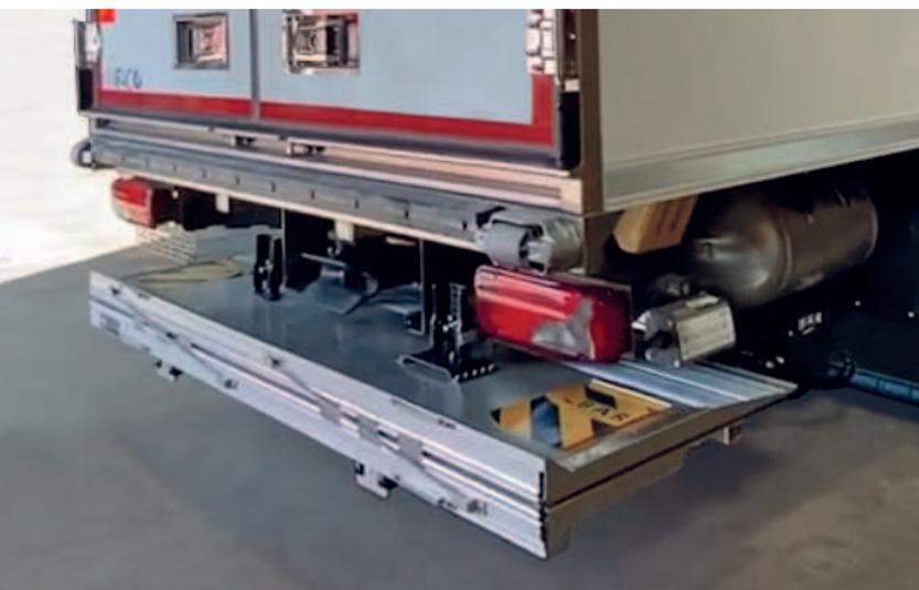
Come Cargolift per camion con peso totale ammesso da 8,6 t a 18,0 t con parti sovrastrutturali fisse di qualsiasi tipo, il BC 1500 R21 può essere utilizzato in modo eclettico. La sua piattaforma con una profondità pari a 1710 mm permette il trasporto di contenitori su ruote o pallets con carrelli elevatori a forche. In qualità di Cargolift retrattile a singolo ripiegamento, può essere messo rapidamente in uso.
