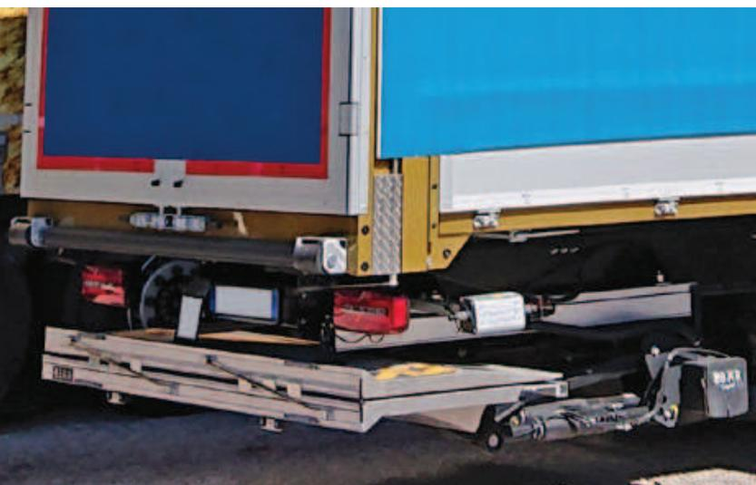
Poiché la distribuzione professionale di merci richiede molto, il BC R41 offre appunto molto: 2000-3000 kg di portata per 1000/800 mm di distanza del carico, nonché una piattaforma profonda fino a 2010 mm sono caratteristiche che ne permettono un uso eclettico. Grazie all'impiego esteso di alluminio, questo Cargolift retrattile presenta un rapporto ottimale tra peso proprio e carico ammissibile. In questo modo, anche ai camion pesanti, rimane un sufficiente carico utile.
