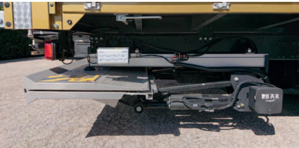
Grado elevato di premontaggio, impiego flessibile e che richiede poca manutenzione – i Cargolift RetFalt della Bär offrono proprio questo. Le piattaforme di carico retrattili possono essere montate rapidamente mediante staffe di fissaggio avvitate sul camion o con attacchi a morsa sul semirimorchio.
