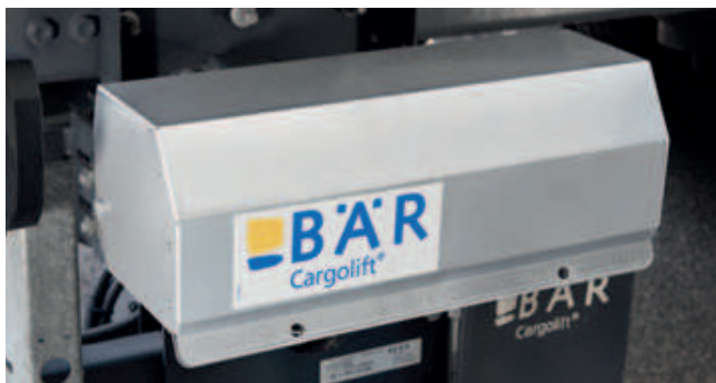
Skyddshuv (tillval) för Bär Control EVO gjord av rostfritt stål.
