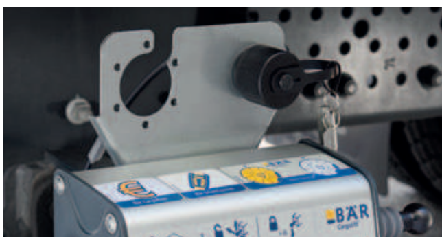
Utvändig elektrisk nyckelbrytare (tillval) för montering på styrenhetshäl-laren. Förhindrar otillåten användning som alternativ till SwitchKey.
