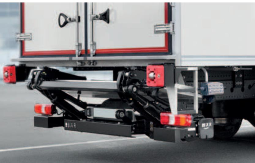
Il BC 1500 F, apribile a mano e dalle dimensioni compatte, offre 1500 chilogrammi di capacità di carico ed è caratterizzato da piattaforme in alluminio con profondità fino a 1.510 mm. A differenza della variante F2, questo modello consente di pareggiare la pendenza in ogni altitudine grazie a due cilindri di inclinazione. Questo aumenta, oltre che alla comodità di comando, anche la sicurezza.
