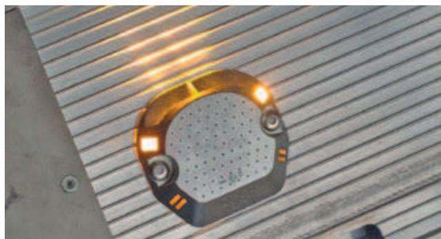
Robuste luci lampeggianti a LED **CargoFlash** (di serie) dalla forte intensità luminosa e dall'irradiazione laterale molto buona con assorbimento ridotto di corrente.
