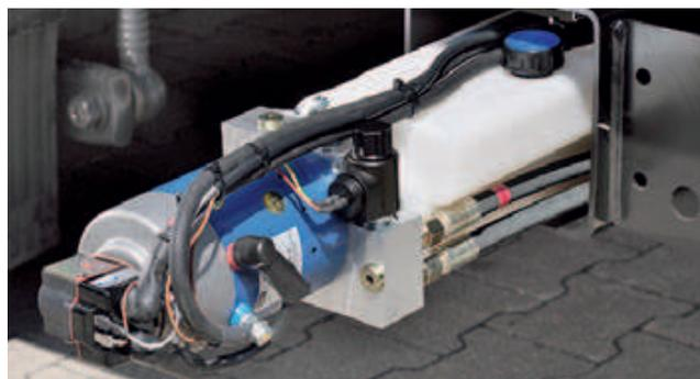
**Gruppo** e **sistema di comando** sono protetti in modo sicuro nel tubo di supporto (di serie). Il motore con interruttore magnetotermico di protezione protegge dal surriscaldamento e dall'incendio del motore stesso. Semplice comando di **emergenza** delle quattro funzioni di base mediante tasti. Come opzione è disponibile un **gruppo a funzionamento silenzioso** (opzionale).
