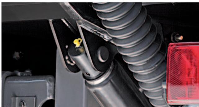
Cilindro idraulico con **tubo di protezione** o **soffietto** (di serie) per proteggere contro gli urti di pietre e dalla corrosione. Apertura rapida e uniforme a motore, anche in inverno, mediante cilindri di inclinazione a doppio effetto.
