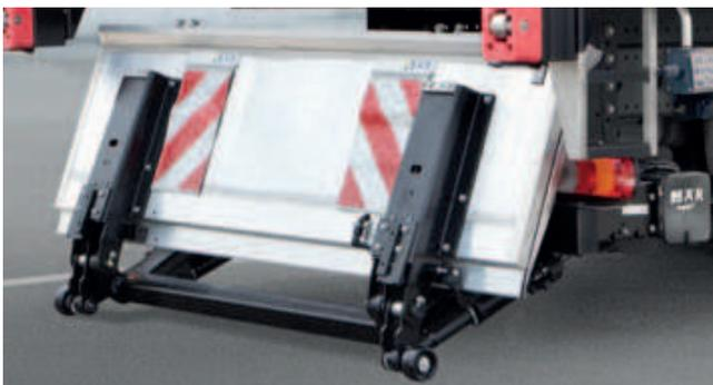
Parte posteriore della piattaforma in **alluminio** al naturale (di serie). Piattaforma **anodizzata** (opzionale) possibile.
