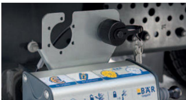
**Interruttore a chiave elettrico, esterno** (opzionale) per il montaggio al supporto dell'unità di comando. Impedisce l'utilizzo involontario come alternativa allo SwitchKey.
