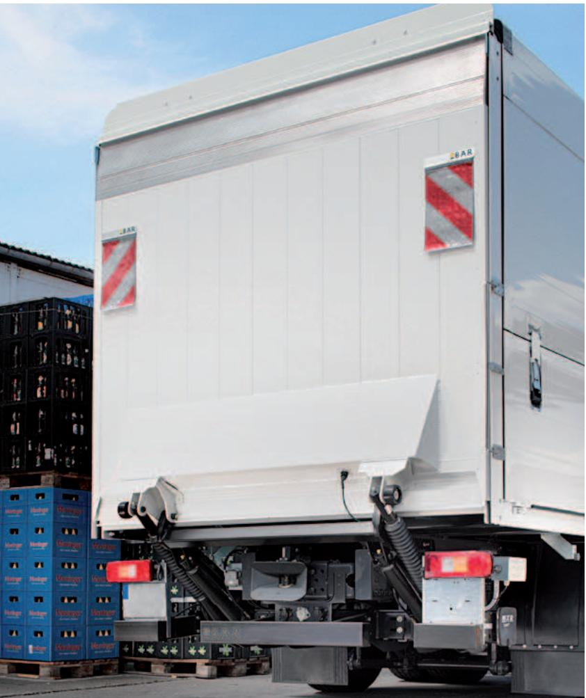
Если грузоподъёмность 2000 кг более не является достаточной для транспортировки палет с помощью электрических подъёмных тележек, то BC 2500 S4 предлагает очевидную альтернативу: грузоподъёмность 2500 кг при расстоянии до груза 1000 мм. Вместе с платформой высотой до 3010 мм этот гидроборт популярен, прежде всего, в логистических системах по перевозке напитков.
