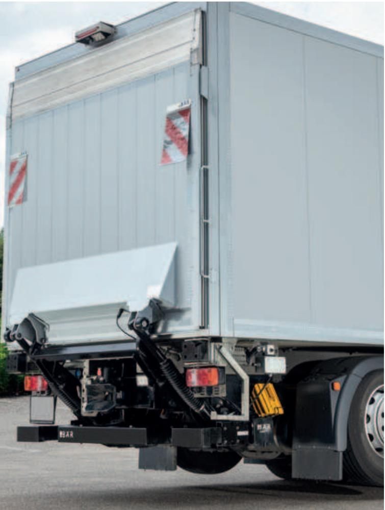
С большим грузовым моментом 20,0 кНм, с непревзойдёнными по устойчивости системами платформы, а также с разнообразными возможностями для монтажа и оснащения BC 2000 S4 уже многие годы является надёжным спутником систем распределения напитков и продуктов питания. Наряду с платформами высотой до трёх метров имеется уникальный по многообразию выбор оснащения со специфическими для отрасли особенностями, например, роллстопами.
