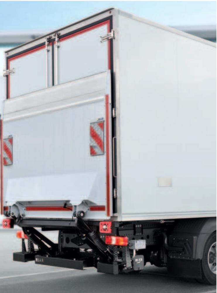
В системах для перевозки мелких грузов, транспортных распределительных системах и системах сборных грузовых перевозок он чувствует себя как дома – в других сегментах он также популярен. Большой грузовой момент 15,0 кНм и проверенные на практике резервы мощности, а также разнообразные опции для монтажа и оснащения легко позволяют „вооружить“ BC 1500 S4 для каждого вида использования.
