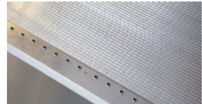
Больше безопасности и больше сцепления с платформой благодаря противоскользящим поверхностям **TracGrip** и **SideGrip** (серия, R11) – а также при мокрой земле. Опционально доступен **TracGrip Plus** с повышенным сопротивлением скольжению R13.
