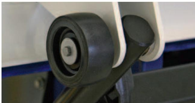
На уровне земли (пола) дополнительное резиновое покрытие **на полных роликах поглощает шум**. Все грузовые подъёмники S4 в Piek-версии оборудованы **агрегатом тихого хода**.
