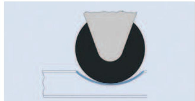
**Тарельчатые выемки** с двойным дном. Поставляются для системы платформы BAplan45VL и AFplan в виде одной пары для одного роликового контейнера по направлению движения слева или в виде двух пар справа и слева. Можно комбинировать с массивными выемками, а также с роллстопом Rs, Rx и Ax. Минимальная высота 2160 мм.
