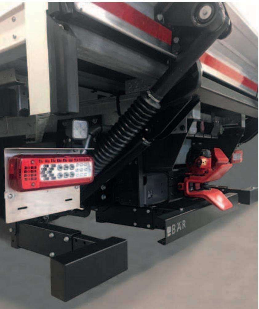
ВС S4V в качестве нового варианта грузоподъёмностью 2000 кг / 2500 кг оборудован противоподкатным бруском с регулируемым положением: по вертикали четыре ступени, по горизонтали семь ступеней. Это позволяет, например, использовать прицепы с изогнутым дышлом. Имеется разнообразное оснащение S4 так же, как и большой грузовой момент.
