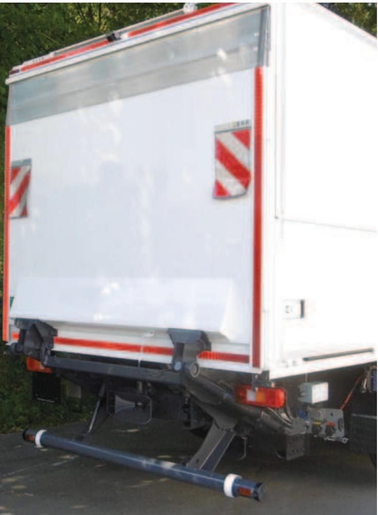
Грузовой момент 25 кНм, то есть 2500 кг при одном метре расстояния до груза, можно использовать очень разнообразно. При этом BC 2500 S4U обладает уже известными преимуществами S4U с точки зрения монтажа и оснащения в сочетании с мощной системой высокого давления.
