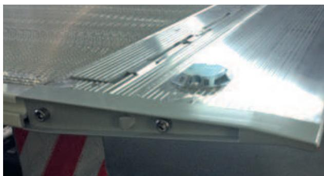
**SteelTop** (опция BAplan45VL, серия BAplan50VL) из массивной легированной стали для защиты углов платформы при разгрузке на рампе.
