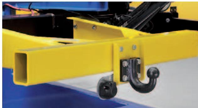
**Кронштейн для тягово-цепного устройства с шаровой головкой** (опция) с Европейским разрешением на эксплуатацию деталей (АВЕ для деталей), параметр D 26,9 кН, нагрузка на сцепной шар макс. 250 кг, вес ок. 25 кг. Требуется электрическое оснащение на транспортном средстве! Дополнительно можно приобрести **шаровую опору сцепления**.
