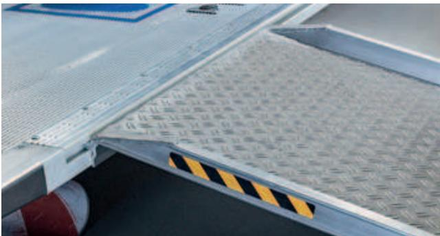
**Кромочный замыкающий профиль** (опция) для бесступенчатой навески бокового **погрузочного трапа** (опция), поставляется без функции точности вождения (длина 1 000 мм; ширина по выбору 600 / 734 / 845 мм).
