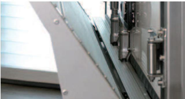
Bär **CargoBridge** (опция - кроме BC 1000 / 3000 S4) для установки платформы позади дверей фургона с закрыванием на поворотные шпингалеты с крючками. Позволяет обойтись без косынки со стороны фургона.
