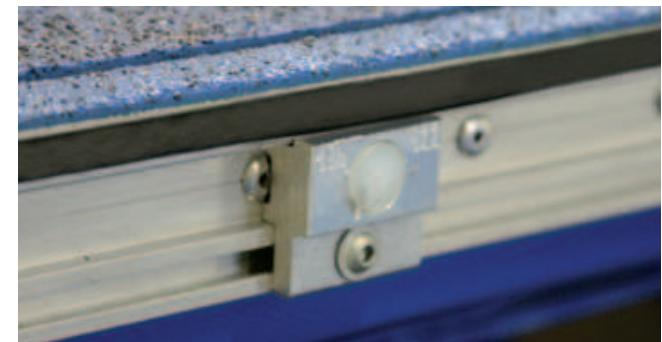
Уплотнитель Bär **CargoSeal** для фургона в Piek-версии (опция) демптирует удар платформы о фургон при закрывании. С резиновым амортизатором в качестве упора подъёмного коромысла при подъёме.
