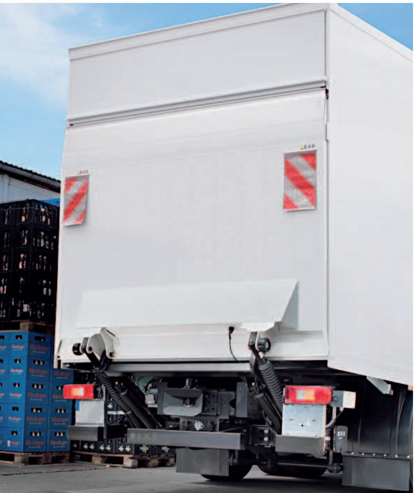
При монтаже на прицепе с поворотным кругом в большинстве случаев остаётся мало места для гидроборта – поэтому BC 2000 S4A требует лишь небольшого свободного пространства 580 мм в задней части транспортного средства. При одновременно большом грузовом моменте и широком разнообразии оснащения.
