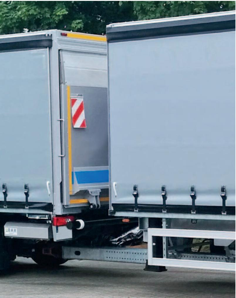
Комбинированный обычный и низко расположенный узел сцепки и дополнительно гидроборт? BC 2000 S4U предоставляет такую возможность, т.к. все конструктивные узлы обеспечивают свободу поворота дышла на угол 180°/6°. Противоподкатный брус при работе прицепа просто отводят вверх – в режиме работы без прицепа он удобно удерживается на земле.
