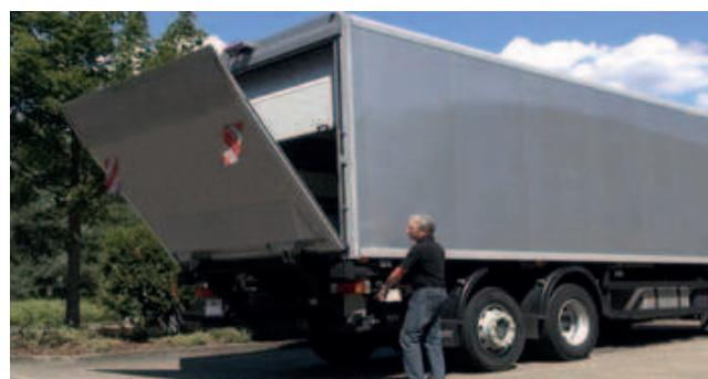
**Система управления шторной дверью Bär** (опция) открывает и закрывает шторную дверь фургона автоматически в зависимости от обслуживания гидроборта; это позволяет облегчить обслуживание и сохранить в фургоне холод.
