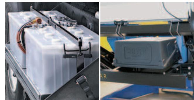
Надёжное электропитание от **аккумуляторного ящика** компании Bär (опция), компактно смонтированного на противоподкатном брусе. Поставляется также как Bär **BatteryBox** (опция) для бокового монтажа под фургоном.
