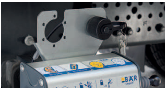
Interruttore a chiave elettrico, esterno (opzionale) per il montaggio al supporto dell'unità di comando. Impedisce l'utilizzo involontario come alternativa allo SwitchKey.
