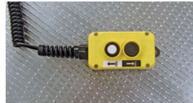
Telecomando via cavo (opzionale) a due funzioni con memoria della posizione di lavoro della piattaforma. Disponibile presa premontata sull'unità di comando o all'interno dell'allestimento.
