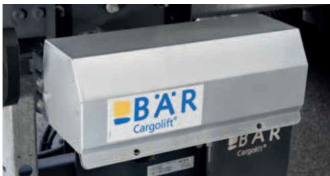
Copertura di protezione (opzionale) per Bär Control EVO in acciaio inossidabile.
